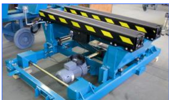
Přesuvný vůz, vedený na kolejničích se zabudovaným teleskopickým dopravníkem pro palety.
