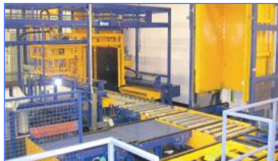
Plně automatická stanice výměny palet pro výměnu cizích palet za vnitropodnikové.
