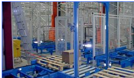
Kontrolní stanice palet pro zjištění jejich délky, šířky, výšky a váhy s integrovanou kontrolou volného prostoru mezi nosníky palet – zjištění jejich orientace
