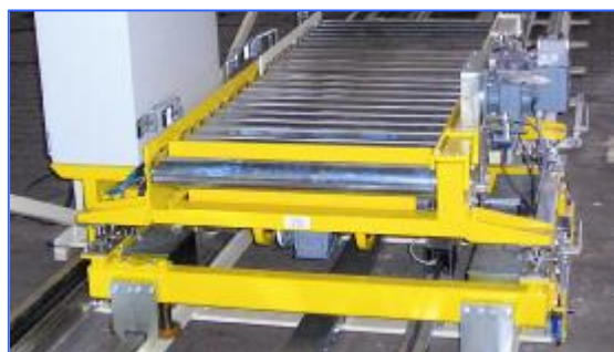
Přesuvný vozík na kolejničích s integrovanou váhou pro plnění kontejnerů s decentralizovaným rozváděčem.
