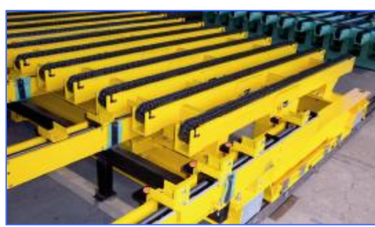
Víceřadý řetězový dopravník pro speciální palety.
