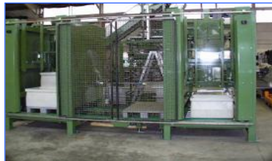
Transportní zařízení k plnění s automatickým stohováním a vyjímáním beden.
