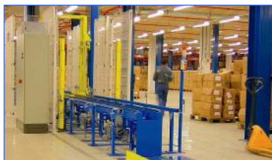
Transportní zařízení pro pojezdné zásobníky (bedny) a pro europalety.
